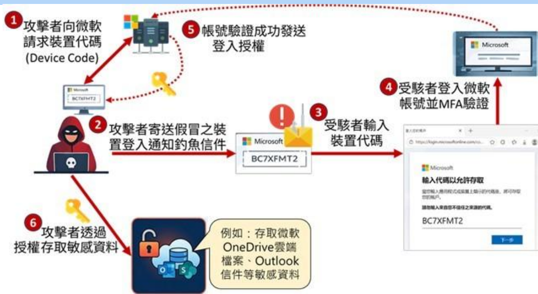
圖2：裝置碼 ( Device Code ) 社交工程攻擊示意流程。資料來源：資安院
